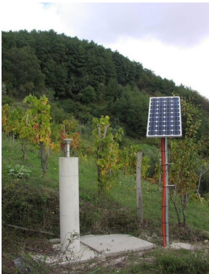
Figura 5 - Monitoraggio in modalità statica con acquisizione in continuo (Frana di Lago, CS). Fonte: archivio GEO-GFI ISPRA.
