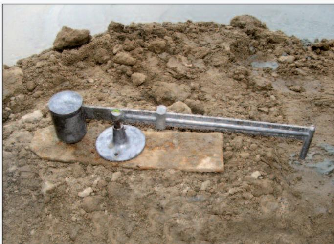
10. Il mud balance per la determinazione del peso del fango
