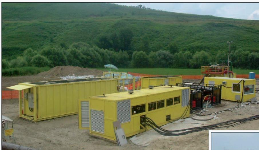
1. Una vista generale di un impianto di miscelazione, riciclaggio e pompaggio della bentonite
