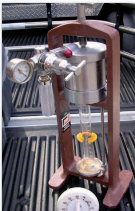
9. La filtropressa per la determinazione del pannello e del filtrato
